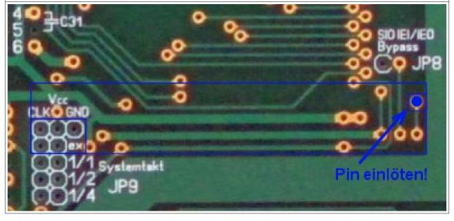
Durch das Einlöten eines Einzelpins in die Durchkontaktierung auf der Hauptplatine unterhalb von "JP8" (=Leiterzug zur SIO RxC/TxC) erhält die Subplatine (mit einer Einzelbuchse entsprechender Lage) Stabilität und man spart sich auch die Leitung zu JP12...
