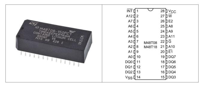
Der Schaltkreis M48T08 ist ein nichtflüchtiger (eingebaute Lithium Zelle) statischer RAM 8k\*8 Bit und fast pinkompatibel (außer Pin1) mit einem 6264. Der "Witz" an der Sache ist, dass die letzten 8 Bytes des Bereiches durch eine ebenfalls eingebaute Echtzeituhr (mit 32kHz-Quarz) beschrieben/aktualisiert werden!
